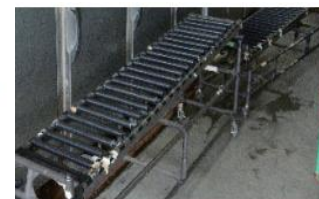
トラックの荷台に可動式のローラーコンベアを設置
