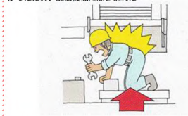
加熱機械の調整作業を行っていたところ、電源を切っていないため、加熱機械にはさまれた
