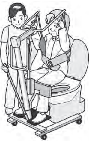
図 7-18 スタンディングマシン 便器への立ち座りの立位補助
