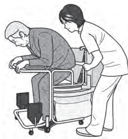
図 7-17 移乗車椅子から便座への腰掛け (車椅子の座面がスライドする)
