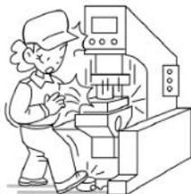
(対策の例) 両手で左右の操作部を操作する**両手操作式**にする。
