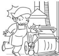
(対策の例) ガードを閉じなければ作動しない**インターロックガード式**にする。
