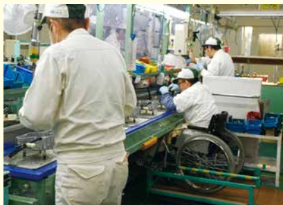
車椅子でも作業可能な作業台の改善
