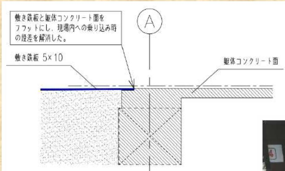
躯体コンクリート面のヌスミを利用して敷き鉄板の高さ調整を行い、乗り込みをフラットにした。
