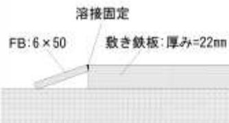
敷き鉄板端部を平滑になるようフラットバーを溶接固定
