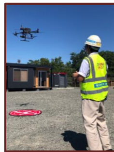
↑ドローン測量の様子
