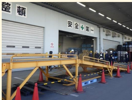
▲コンテナ車へのアプローチ用の フォークリフト専用スロープ
