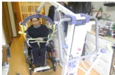
被介護者が車いすに座れたことを確認したらリフトのフックからシートのストラップを外し、シートを抜き取る。
