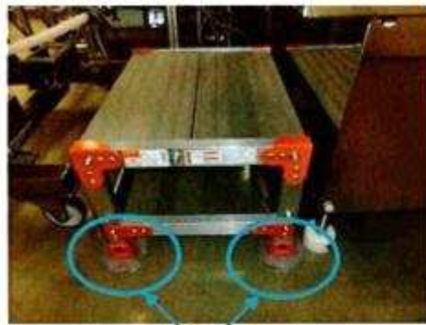
円板取付箇所
