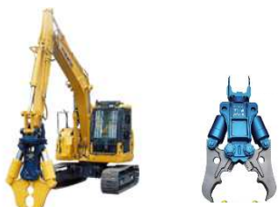
コンクリート圧砕機(コマツ製、同社提供)とアタッチメントのコンクリート圧砕具(大創)
