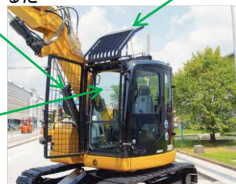
運転室周りの飛来物防護設備の例
