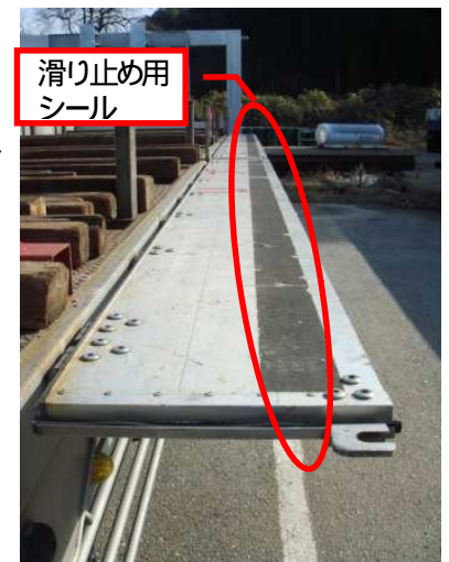
(写真18)作業床状態のあおり
