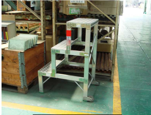
(写真11)低い昇降設備
