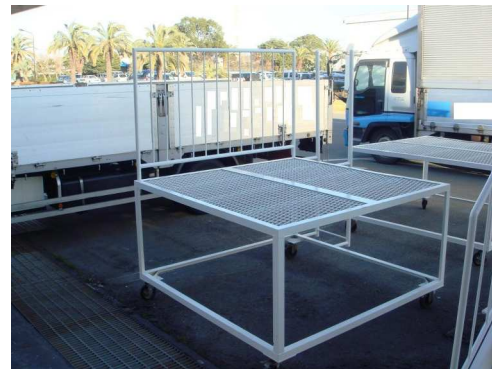
(写真10)低 高さの移動式プラットホーム
