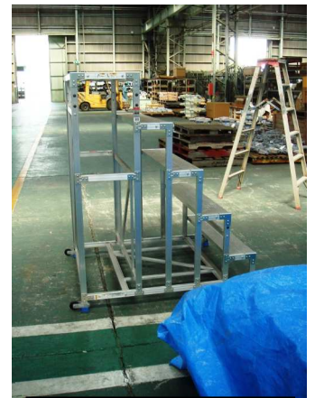
(写真12)高い昇降設備
