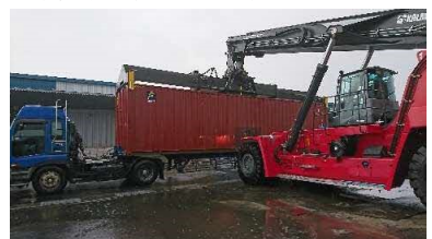
リーチスタッカーによる作業
