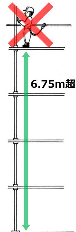
※ 一般的な建設作業の場合は5mを超える箇所、柱上作業等の場合は2m以上の箇所では、フルハーネス型の使用が推奨されます。
