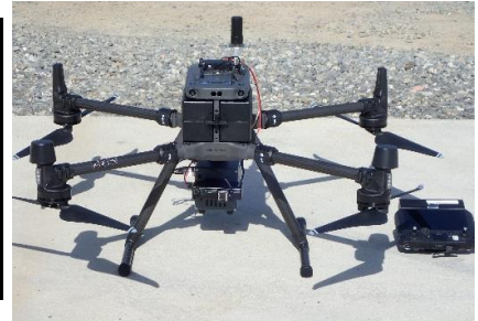
UAV3次元レーザー（ドローン）
