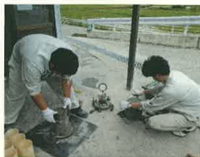
生コンクリート試験の様子
