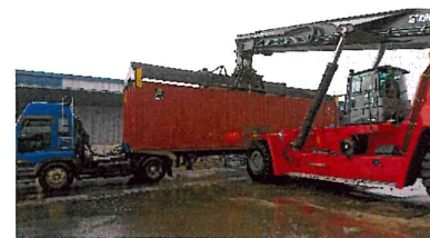
リーチスタッカーによる作業
