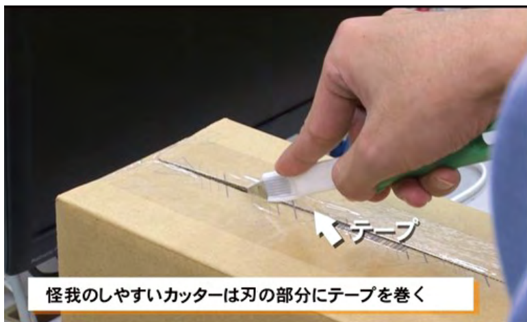
カッターの刃の部分にテープを巻いて安全確保
