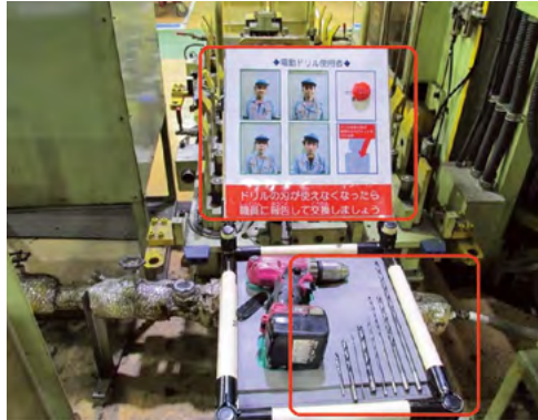
改善後のドリルの刃の保管（第一段階）
