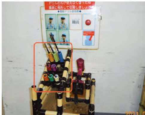
改善後のドリルの刃の保管（第二段階）
