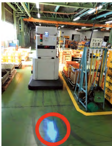
搬送装置のライトから床面に 進行方向を矢印で投影
