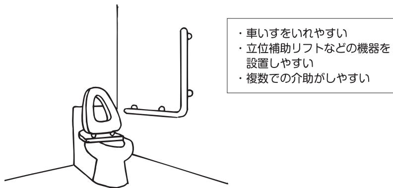
図 6-2-15 広い空間が確保されたトイレ
