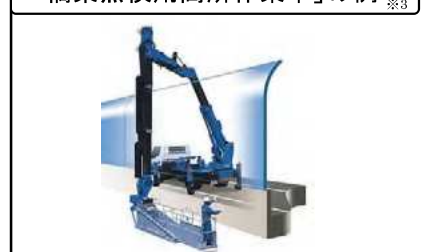
「橋梁点検用高所作業車」の例 ※3
