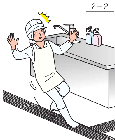
グレーチングで、転倒の危険
