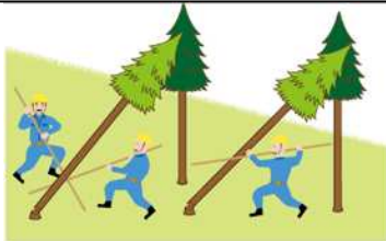
(図2) かかり木の処理
