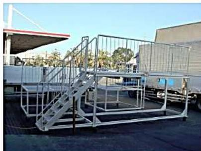
(写真9)階段付きの移動式プラットホーム
