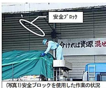
(写真1)安全ブロックを使用した作業の状況
