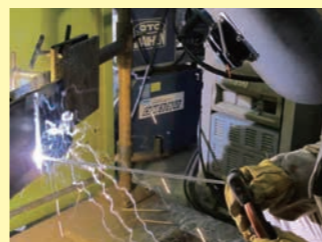
▲被覆アーク溶接の実習風景
