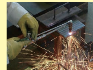
▲ガス切断の実習風景
