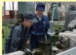
旋盤、フライス盤といった工作機械を用いて、金属材料を加工し製品を作り出す技能を習得します。
