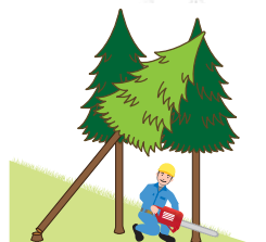
(図3)かかっている立木の伐倒
