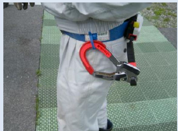
安全帯のフックに蛍光マーカーを貼付し、安全帯を着用・ 使用していることについて、職長や他の作業員から見て 分かるようにしている ○色と語句による安全帯使用の注意喚起
