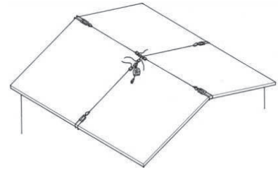
けらばに近づく場合は、親綱固定ロープによる補強を行う
