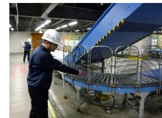
安全柵の設置を確認
