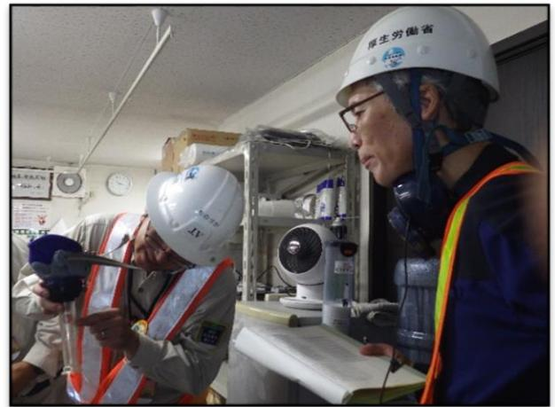
電動ファン付き呼吸用保護具の点検状況（フィルターの交換目安に簡易な風量計でも確認可能）
