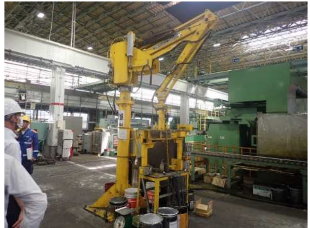
( 腰痛の防止のため、重量物取り扱いのために導入しているバランサー（助力装置）。 )
