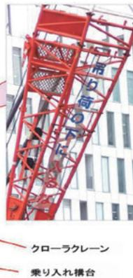
クローラクレーン(移動式クレーン)の根本ジブに「吊り荷の下に入るな」の表示をし、つり荷の下への立入禁止により、つり荷と作業者の接触防止について玉掛作業従事者等に注意喚起している。
