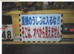
重機後部が運転席から死角であることを表示、重機後部に立込んだ人への注意喚起をしている。
