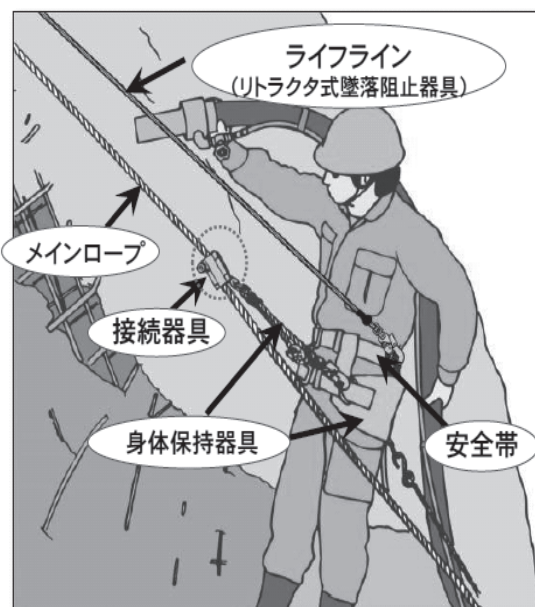
のり面保護工事でのロープ高所作業の例
