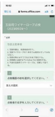
QRコードを用いて玉掛けワイヤロープの点検結果やヒヤリハット報告を入力
