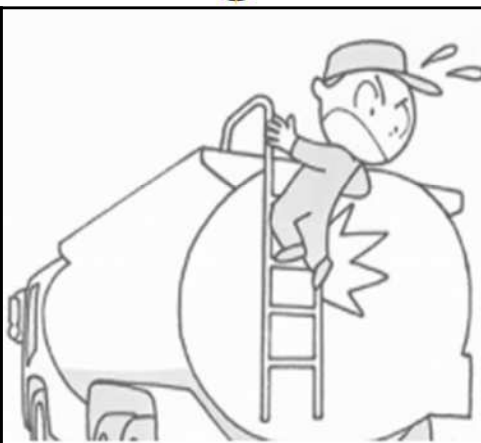
タンクローリー頂部からの降車の際、タラップを踏み外し転落する。
