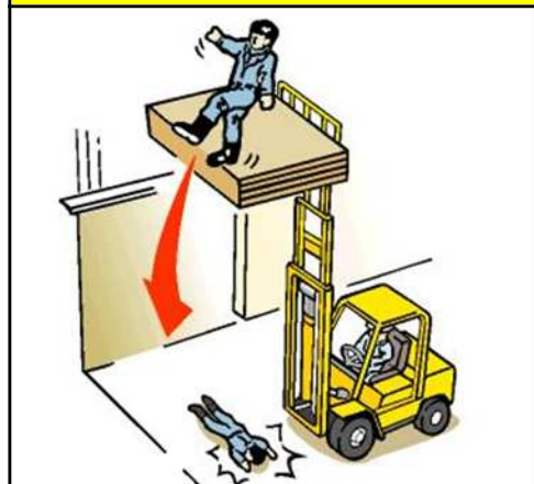
フォークリフトのフォーク上で作業中に転落（用途外使用）
