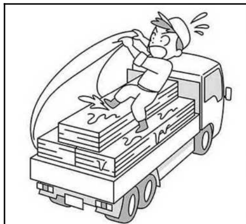
シート掛け（シート外し）中にトラックの荷台から墜落する。
