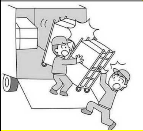
かご車を用いて荷下ろし中、かご車荷台から転落して下敷きになる
