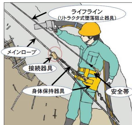
のり面保護工事でのロープ高所作業の例
