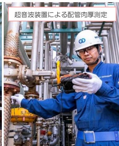
超音波装置による配管肉厚測定
