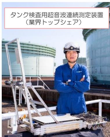
タンク検査用超音波連続測定装置
