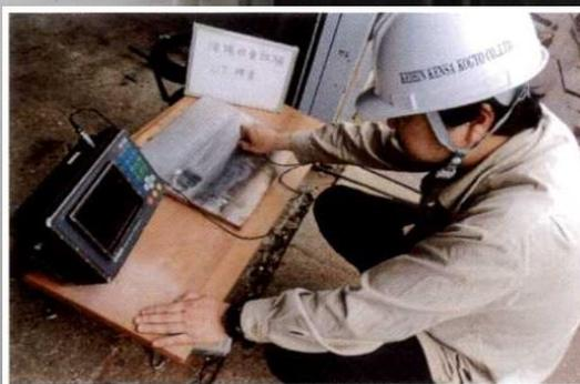
試験片の深傷検査状況
