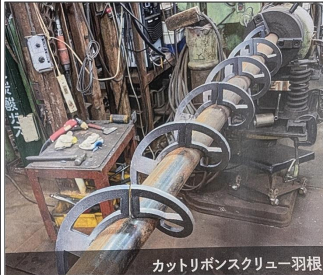
スクリー外径機械加工中
