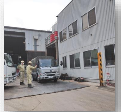
ココの鉄板が台貫(だいかん) 乗るとトラックの重さが量れます
