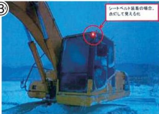
建設機械のシートベルト着用運動として、運転者がシートベルトを装着しているか否かを遠くからでも判別できるよう明示している。
