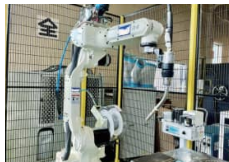
溶接ロボット
