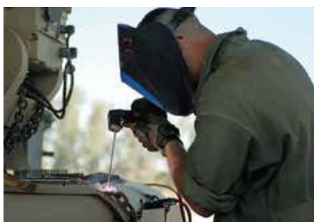
被覆アーク溶接
