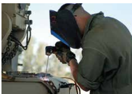
被覆アーク溶接
