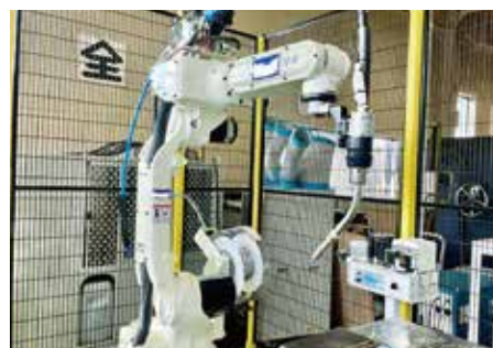
溶接ロボット
