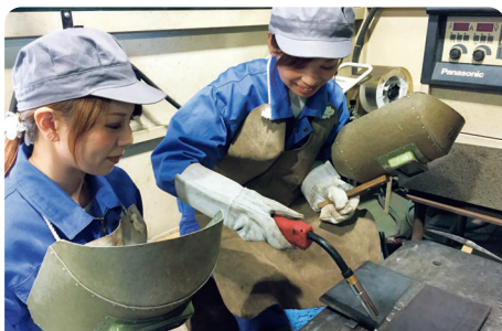
炭酸ガスアーク溶接作業
