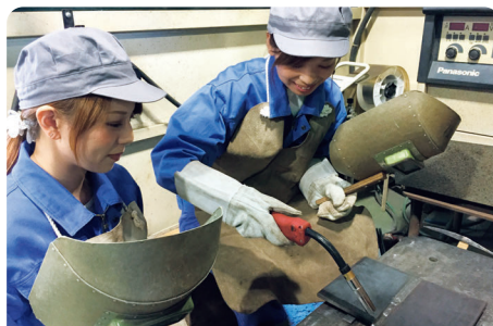
炭酸ガスアーク溶接作業
