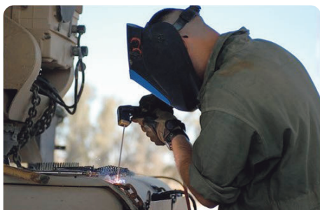
被覆アーク溶接作業
