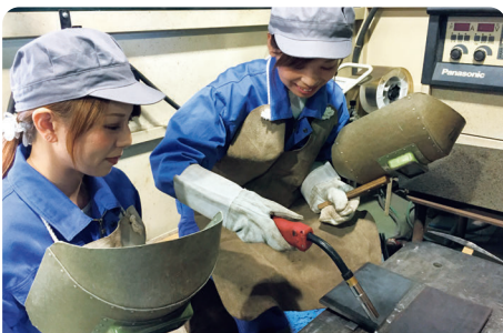
炭酸ガスアーク溶接作業
