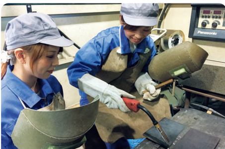
炭酸ガスアーク溶接作業
